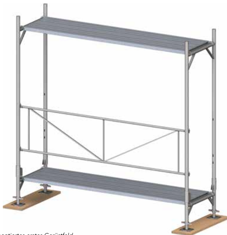
Bild 8: Fertig montiertes erstes Gerüstfeld.
