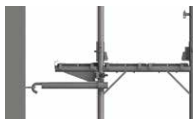
Bild 24: Gerüsthalter, Konfiguration mit Innenkonsolen.
