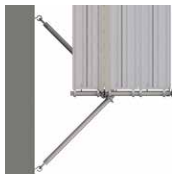
Bild 26: V-Halter, Konfiguration mit Innenkonsolen.
