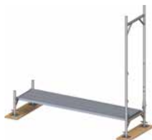
Bild 16: Aufstecken eines Gerüststrahmens.
