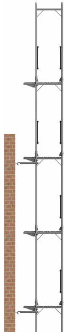
Bild 43: Frei stehende Gerüstlage als Zwischenzustand beim Errichten von Gebäuden.
